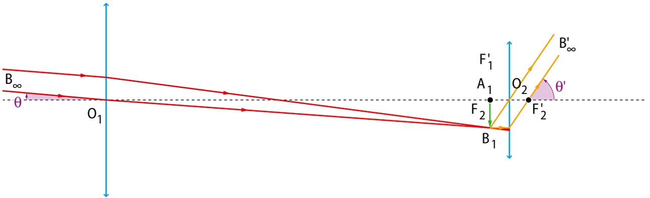
1. Les deux rayons représentés en rouge arrivent sur l'objectif avec une inclinaison  $\theta$  par rapport à l'axe optique
