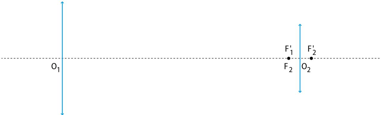
a. Avec une échelle 1/10 le long de l'axe optique, la distance  $O_1O_2 = 105$  cm mesure  $\frac{105}{10}$  soit 10,5 cm sur le schéma.
